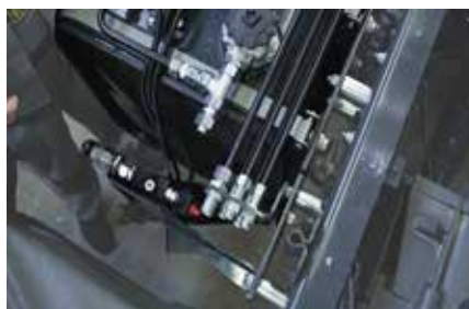
Dauerhaft vor Korrosion geschützt: Kunststoffbeschichtete Stahlleitungen.
